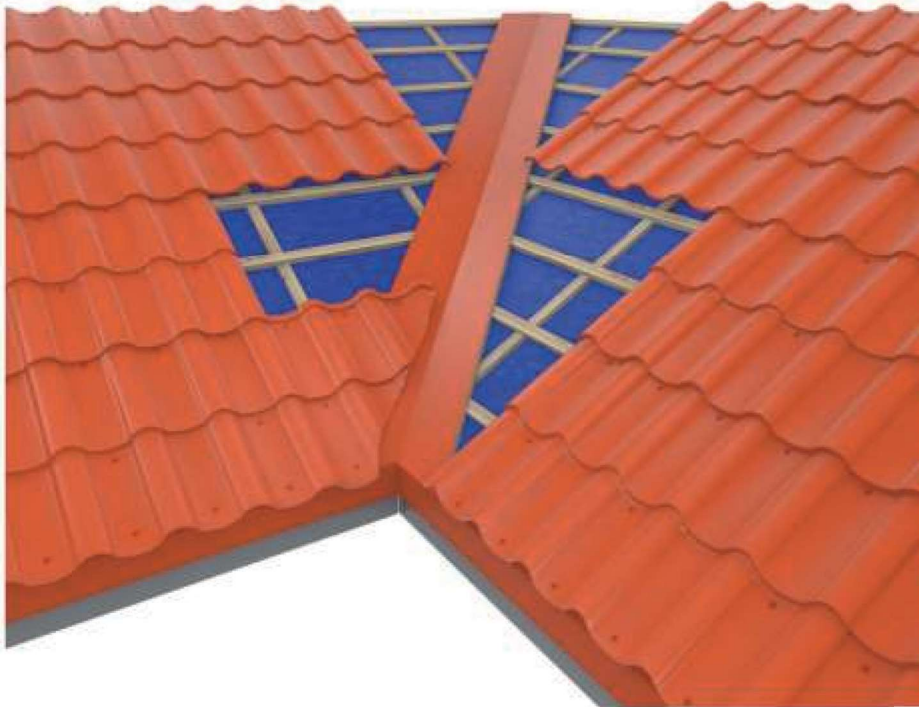
Mögliche Reihenfolge der Paneelmontage in der Kehle und Kehlrinne
